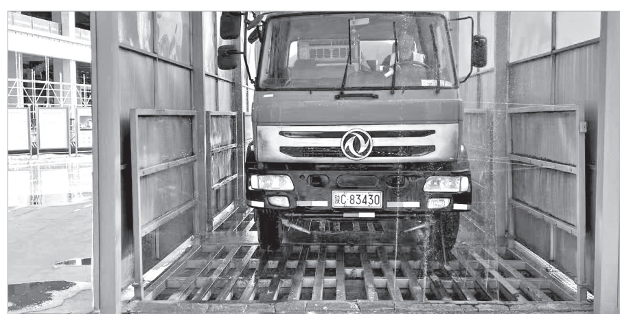
出工地前车辆轮胎在洗车台上清洗
